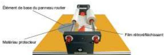
Quand on colle plusieurs lés, ils doivent toujours se chevaucher. Le chevauchement doit être compris entre 3 et 5 mm en fonction du format et il faut toujours veiller à coller les lés côté droit contre côté droit et côté gauche contre côté gauche.
