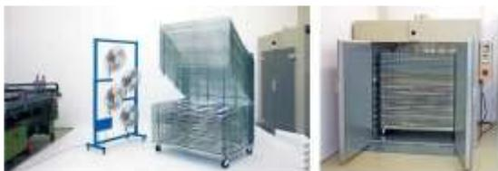
L'emploi d'étuves à convection est une autre possibilité d'optimisation des conditions de chauffage. Ces systèmes clos assurent un séchage à faible contamination en poussière, avec une température très constante, une faible humidité et sans exposer l'opérateur à des vapeurs de solvants.
